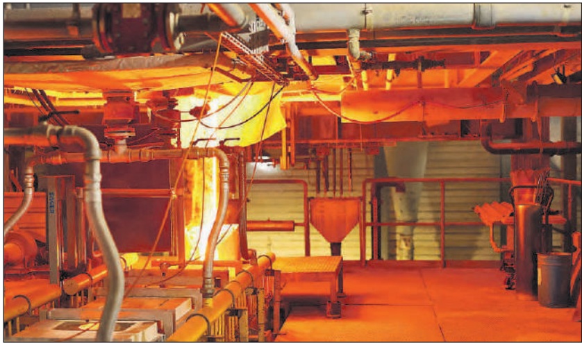
Hier wird das Glas auf ca. 1400 Grad erhitzt, bevor es zu Glaswolle verarbeitet wird.
